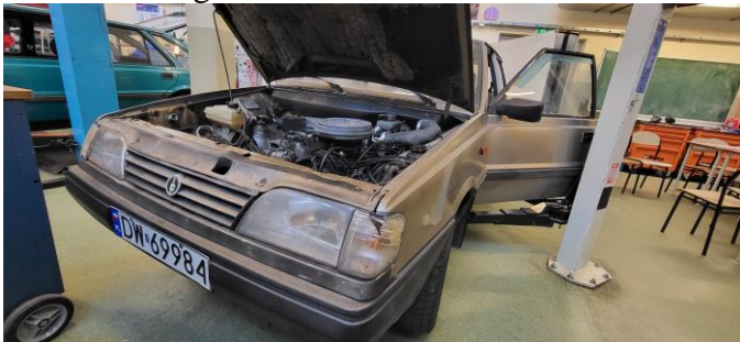
Rys Poldek egzaminacyjny nr 1: wtrysk i zapłon elektroniczny
