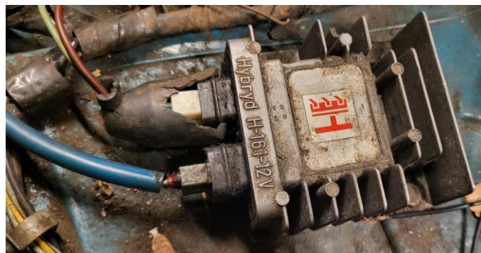
Rys. Moduł zapłonowy współpracujący z czujnikiem i cewką
