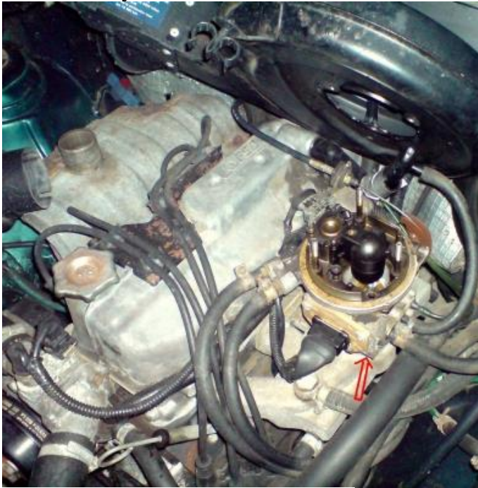
Rys. Silnik Poloneza 1600 „na jednej szprycy”
