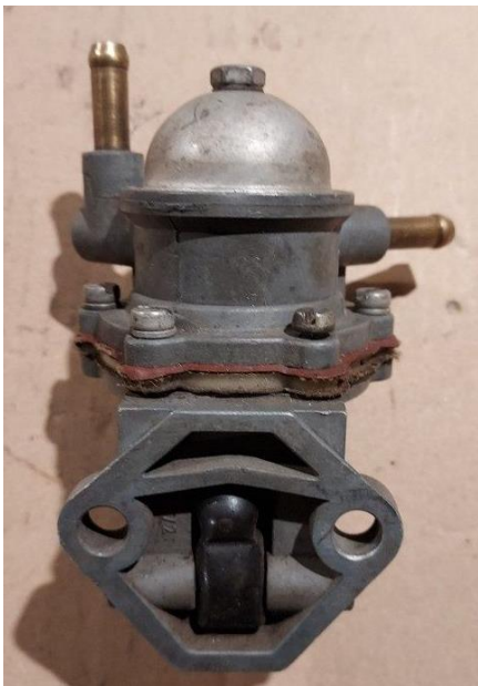
Rys. Przeponowa pompa paliwa silnika gaźnikowego 1,5 i 1,6
