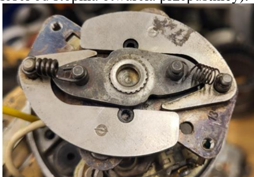
Rys. Regulator odśrodkowy kąta wyprzedzenia zapłonu
