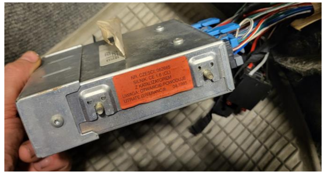
Rys. Sterownik wtrysku i zapłonu w Polonezach warsztatowych
