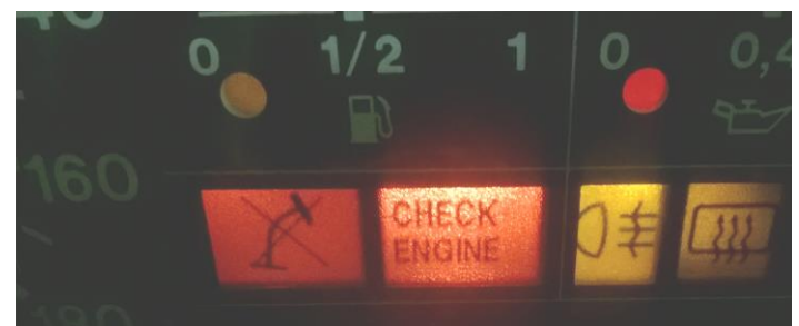
Rys. Kontrolka „CHECK ENGINE” – sprawdź silnik.
