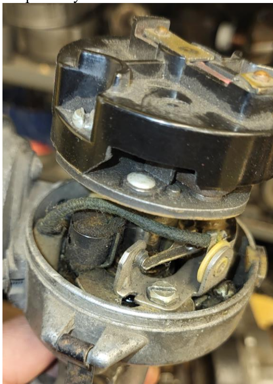
Rys. Najstarszy aparat zapłonowy (stykowy przerywacz)
