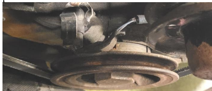
Rys. Koło pasowe wału korbowego z impulsatorem i czujnikiem
