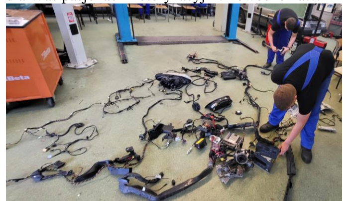
Fot. Uczniowie Borowskiej ze sterownikami ECU, ABS, Klima, Licznik, Comfort – a potem diagnostyka komputerowa
