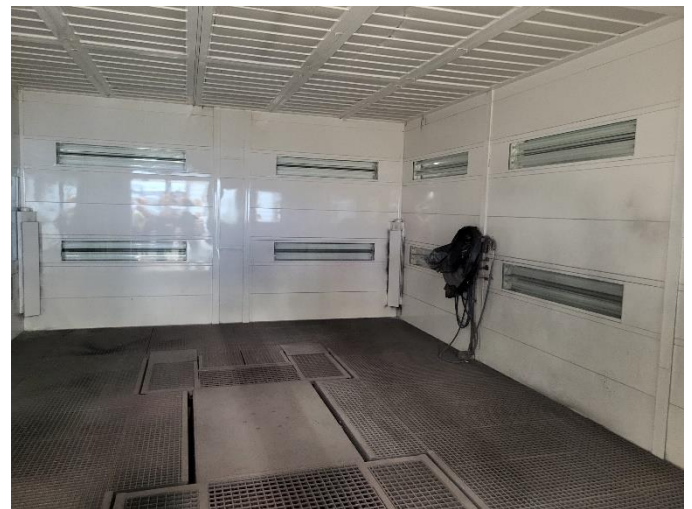
Fot: Bezpyłowa lakiernia z potężnymi odciągami
