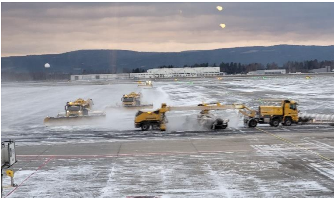
Fot: Pługi odsnieżające płytę lotniska w Oslo
